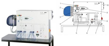
HL 356 démontre le mode de fonctionnement fondamental et le comportement typique d'un brûleur à gaz lors de perturbations de fonctionnement.
