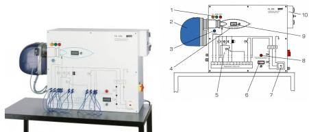
HL 356 démontre le mode de fonctionnement fondamental et le comportement typique d'un brûleur à gaz d'origine lors de perturbations de fonctionnement.
