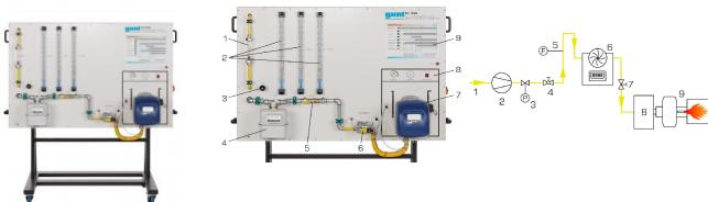
Le banc d'essai contient un brûleur à gaz à air soufflé du commerce.
