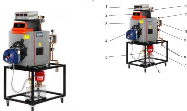
Le banc d'essai est équipé d'un brûleur à fioul.
