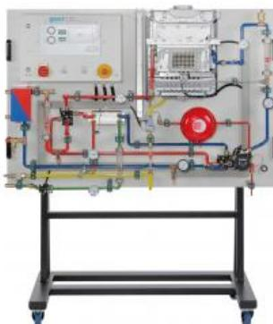
HL 530 illustre le fonctionnement d'une chaudière murale à double service (chauffage/eau chaude) à gaz. Les composants principaux de la chaudière murale à gaz sont disposés de manière claire sur un panneau afin de faciliter la compréhension.
