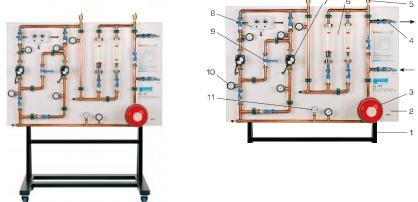
Le banc d'essai comprend un système de tuyauterie avec deux pompes de circulation.
