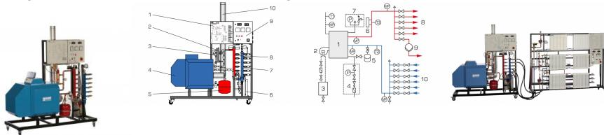
Le HL 353 pour la production d'eau chaude sert d'unité d'alimentation pour les bancs d'essai HL 353.01 et HL 353.02. Il est possible de monter une installation de chauffage complète en combinaison avec les HL 353.01 et/ou HL 353.02. Tous les composants sont usuels en technique de chauffage et offrent un rapport pratique élevé.
