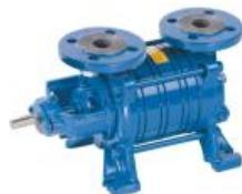
Les pompes à canal latéral sont des pompes centrifuges autoamorçantes largement répandues. Elles permettent d'atteindre des pressions de refoulement relativement élevées pour de faibles débits. Elles peuvent aspirer et refouler des fluides qui contiennent des gaz.
