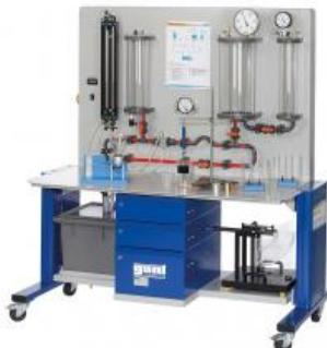
**HM 115 Banc d'essai d'hydrostatique (Réf. 070.11500)**
