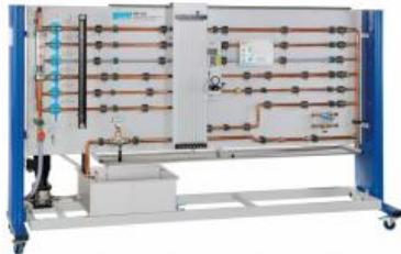
La connaissance des pertes de charge dans différents éléments de tuyauterie joue un rôle important dans le dimensionnement des systèmes de tuyauterie.
