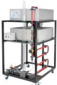
Les processus d'écoulement non stationnaires sont pris en compte lors du dimensionnement des réservoirs d'eau. Ces processus apparaissent par exemple dans les bassins de retenue des eaux de pluie et dans les lacs artificiels. Le principal objectif du bassin de retenue des eaux de pluie est de différer le processus d'écoulement en procédant à un stockage intermédiaire temporaire.
