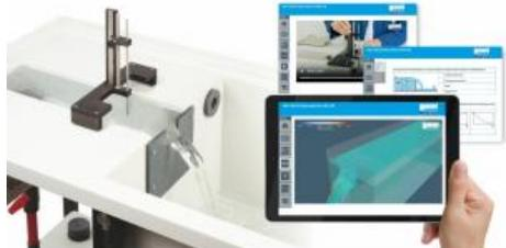
Les déversoirs à paroi mince font partie des ouvrages de contrôle du débit qui permettent de contrôler les écoulements dans un canal.
