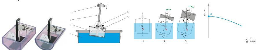
L'accessoire HM 150.39 comprend deux corps flottants transparents avec des formes de membrure différentes (bouchain vif et bouchain adouci).
