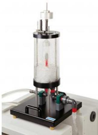
Le fait de ralentir, accélérer ou changer la direction dun fluide en écoulement modifie sa vitesse, ce qui entraîne une modification de limpulsion.
