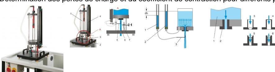
Les pertes de charge lors de la vidange sont liées principalement à deux processus: la déviation du jet à l'entrée dans l'orifice et le frottement des parois dans l'orifice.
