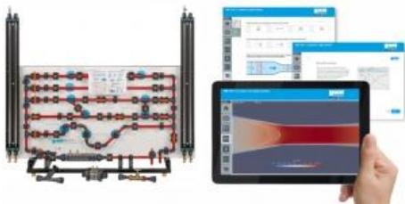
Lors de l'écoulement de fluides réels, des pertes de charge se produisent en raison de frottements et de turbulences (tourbillons).
