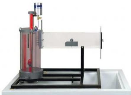
Le banc dessai HM 150.21 permet de visualiser les écoulements autour de corps de résistance et les phénomènes découllement dans des canaux ouverts.
