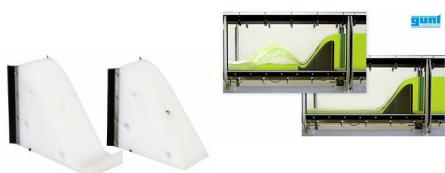
Les déversoirs à crête arrondie sont des déversoirs fixes qui font partie des ouvrages de contrôle.
