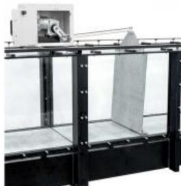
Les vagues de surface sont générées par une plaque de refoulement qui exécute un mouvement pivotant. La plaque est entraînée par un moteur avec convertisseur de fréquence par le biais d'un système bielle-manivelle.
