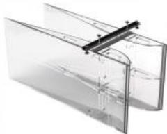
On détermine le débit d'un canal à l'aide de canaux jaugeurs.
