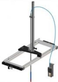
L'élément principal du tachymètre HM 161.64 est une roue à ailettes qui tourne sous l'effet de l'écoulement.
