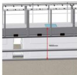
L'accessoire HM 161.83 est une vitre en verre pour le canal d'essai HM 161, qui est destinée à être utilisée avec un système PIV, par ex. le HM 161.81.
