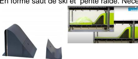
Les déversoirs à crête arrondie sont des déversoirs fixes qui font partie des ouvrages de contrôle.
