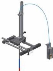
L'élément principal du tachymètre HM 162.64 est une roue à ailettes qui tourne sous l'effet de l'écoulement.
