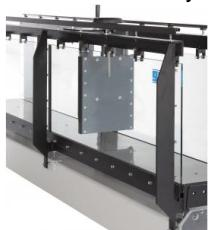
Les vannes planes font partie des ouvrages de contrôle mobiles; l'écoulement les traverse par dessous.
