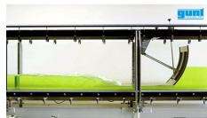
Les vannes radiales font partie des ouvrages de contrôle mobiles; l'écoulement les traverse par dessous. L'élément principal de la vanne radiale est une paroi ayant la forme d'un segment circulaire qui produit une retenue dans un canal traversé par un écoulement.
