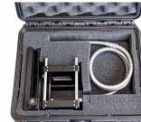
Un système PIV (Particle Image Velocimetry) permet de enregistrer des champs de vitesse dans la section dessai. L'accessoire HM 162.81 contient un système complet avec technique de nappe lumineuse, caméra et synchroniseur. Ce système est adapté aux mesures découlement bidimensionnelles.
