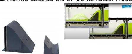
Les déversoirs à crête arrondie sont des déversoirs fixes qui font partie des ouvrages de contrôle.
