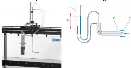
Le tube de Prandtl HM 162.50 est un dispositif de mesure de la vitesse d'écoulement dans le canal d'essai HM 162. Il mesure la pression statique et la pression totale au point souhaité de l'écoulement.
