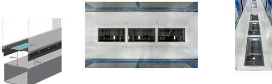
L'accessoire HM 162.83 est une vitre en verre pour le canal dessai HM 162, qui est destinée à être utilisée avec un système PIV, par ex. le HM 162.81.
