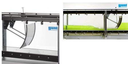
Les vannes radiales font partie des ouvrages de contrôle mobiles; l'écoulement les traverse par dessous.
