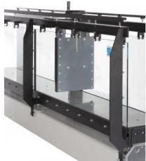
Les vannes planes font partie des ouvrages de contrôle mobiles; l'écoulement les traverse par dessous. Une vanne plane est une paroi verticale qui produit une retenue dans un canal traversé par un écoulement.
