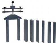
Les obstacles présents dans le canal réduisent la section d'écoulement.
