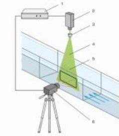
Un système PIV (Particle Image Velocimetry) permet de renregistrer des champs de vitesse dans la section dessai. L'accessoire HM 163.81 contient un système complet avec technique de nappe lumineuse, caméra et synchroniseur. Ce système est adapté aux mesures découlement bidimensionnelles.
