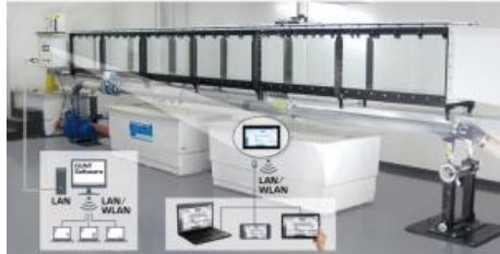
Dans les domaines de l'enseignement et de la recherche, les canaux d'essai sont utilisés pour observer et analyser les phénomènes d'écoulement dans des canaux à l'échelle du laboratoire.
