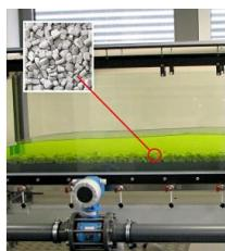
Le comportement d'écoulement d'une rivière dépend essentiellement, à débit égal, de la pente et de la rugosité du fond du canal.
