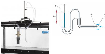
Le tube de Prandtl HM 163.50 est un dispositif de mesure de la vitesse d'écoulement dans le canal d'essai HM 163. Il mesure la pression statique et la pression totale au point souhaité de l'écoulement.
