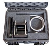
Un système PIV (Particle Image Velocimetry) permet de enregistrer des champs de vitesse dans la section dessai. L'accessoire HM 163.81 contient un système complet avec technique de nappe lumineuse, caméra et synchroniseur. Ce système est adapté aux mesures découlement bidimensionnelles.
