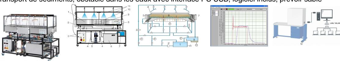
Le HM 145 permet d'étudier les écoulements d'infiltration et les écoulements souterrains après des précipitations.
