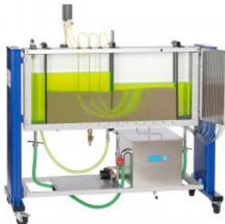
**HM 169 Visualisation écoulements infiltration, étude pression sur les ouvrages (Réf. 070.16900)**
