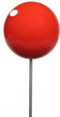
Le corps de résistance sphère est étudié dans la section de mesure de la soufflerie HM 170. Le corps de résistance se compose d'une sphère et d'une barre de maintien en acier inoxydable. La sphère est peinte en rouge. Le corps est placé dans le capteur de force qui mesure la force de traînée opposée par le corps à l'écoulement.
