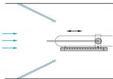
L'appareil d'essai se compose de deux éléments cunéiformes avec lesquels une réduction constante de la section est produite dans la section de mesure de la soufflerie.
