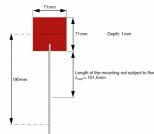
Le corps de résistance carré percé est étudié dans la section de mesure de la soufflerie HM 170.
