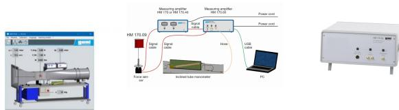
Le système d'acquisition des données a été spécialement mis au point pour simplifier l'analyse des essais réalisés avec la soufflerie HM 170.
