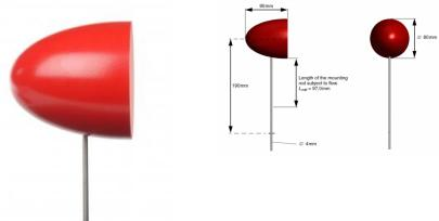
Le corps de résistance paraboloïde est étudié dans la section de mesure de la soufflerie HM 170.
