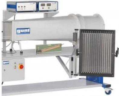
Le manomètre HM 170.50 sert à indiquer simultanément jusqu'à 16 pressions différentielles mesurées en millimètres de colonne d'eau.
