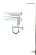
Le tube de Prandtl fournit la différence entre la pression totale dans un écoulement et la pression statique. Le tube est reliée à un manomètre à pression différentielle qui indique la pression dynamique représentative de la vitesse découlement.
