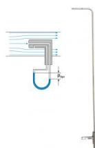
Le tube de Prandtl fournit la différence entre la pression totale dans un écoulement et la pression statique. Le tube est reliée à un manomètre à pression différentielle qui indique la pression dynamique représentative de la vitesse découlement.
