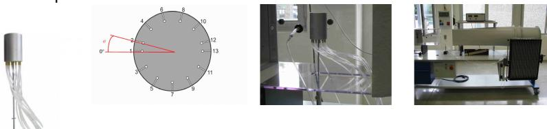
Le modèle HM 170.23 sert à déterminer la distribution de pression sur un cylindre soumis à un écoulement autour de corps.
