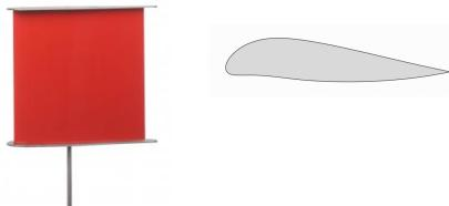
Le corps de portance aile est étudié dans la section de mesure de la soufflerie HM 170.
