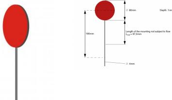
Le corps de résistance disque circulaire est étudié dans la section de mesure de la soufflerie HM 170.
