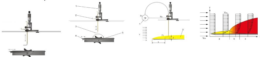
Lorsque des corps sont soumis à un écoulement incident, les fluides comme par exemple l'air adhèrent à la surface du corps et forment une couche dite limite.
