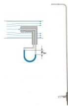
Le tube de Prandtl fournit la différence entre la pression totale dans un écoulement et la pression statique.
