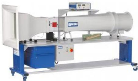
La soufflerie ouverte est l'appareil classique utilisé pour les essais réalisés sur les écoulements aérodynamiques.
