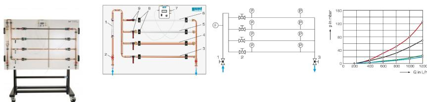
Dans des tuyaux traversés par un écoulement, des pertes de charge ont lieu suite au frottement entre les parois du tuyau et l'eau.
