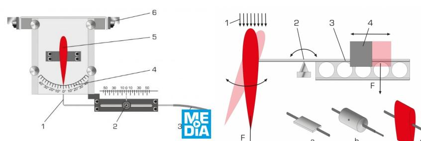
Enregistrement de la répartition de la pression à l'aide du tube de Pitot: 1 tube de Pitot, 2 ajustage horizontal du tube de Pitot, 3 record du manomètre à tube (HM 225), 4 échelle d'ajustage de l'angle d'approche, 5 modèle d'aile, 6 raccord rapide pour connexion sur HM 225
