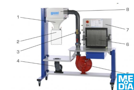
1 buse, 2 section de mesure à monter, 3 thermomètre, 4 tuyau d'air extrait, 5 ventilateur radial, 6 manomètre à tubes, 7 coffret de distribution avec ajustage de la vitesse, 8 chambre de stabilisation avec redresseur d'écoulement
