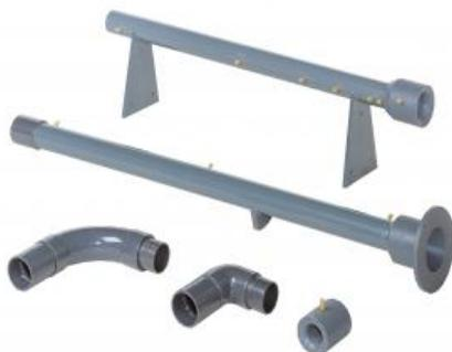
Les pertes de charge dans un écoulement tubulaire de fluides incompressibles entraînent des pertes de charge dans les conduites. Dans le cadre d'essais de base, on observe les pertes de charge dans des sections de tuyau rectilignes ainsi que les pertes de charge suite à un décollement de l'écoulement dans des éléments de tuyauterie tels que des coudues ou des élargissements.
