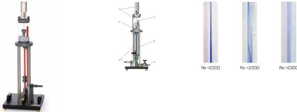
Un écoulement laminaire et un écoulement turbulent sont représentés durant l'essai d'Osborne Reynolds.
