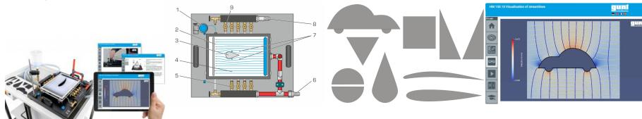
L'écoulement laminaire bidimensionnel de HM 150.10 donne une bonne approche de l'écoulement de fluides idéaux ou écoulement potentiel.
