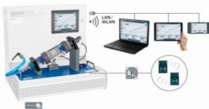
Dans l'équation de continuité, la relation entre la surface de section traversée et la vitesse de l'écoulement est analysée.
