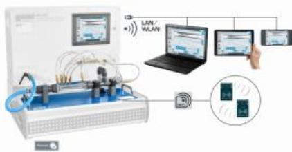
L'accessoire HM 250.07 est utilisé pour étudier la relation entre la vitesse découlement d'un fluide et sa pression dans une buse Venturi.
