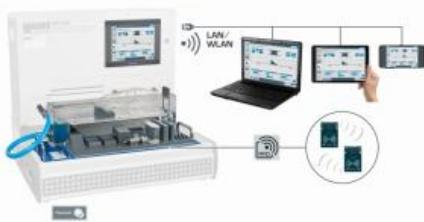
L'appareil de test HM 250.11 est utilisé pour démontrer les effets produits par différents obstacles sur la hauteur dénergie dans des écoulements dans des canaux.
