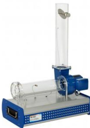
Les ventilateurs radiaux sont utilisés pour l'acheminement de gaz lorsque les différentiels de pression ne sont pas trop importants.
