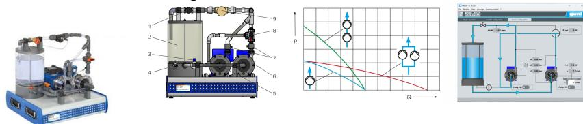
Dans les installations complexes, il est possible d'utiliser des pompes montées en série ou en parallèle. Les hauteurs de refoulement sajoutent pour le montage en série, et les débits de refoulement sajoutent pour le montage en parallèle.
