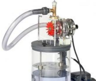
Les turbines Pelton font partie des turbines à action.
