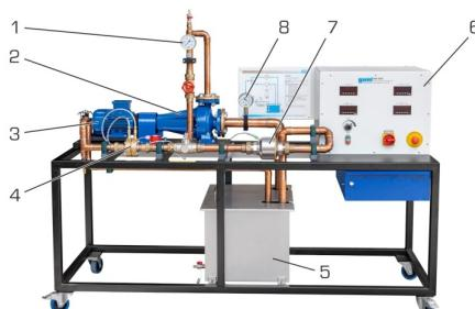
1 manomètre à la sortie, 2 pompe centrifuge, 3 moteur d'entraînement,
