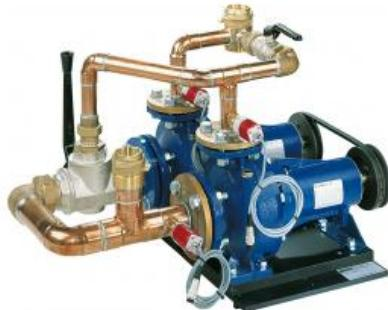
**HM 365.14 2x Pompes centrifuges, montage en série et en parallèle pour HM365.10 (Réf. 070.36514)**
